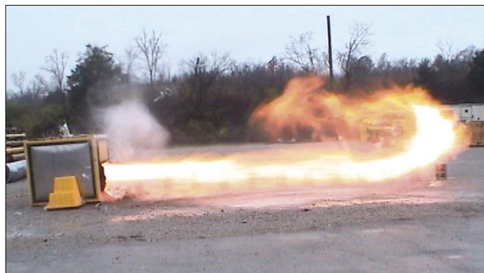
Rys. 5. Otwarcie płyty bezpieczeństwa i widoczny język ognia
