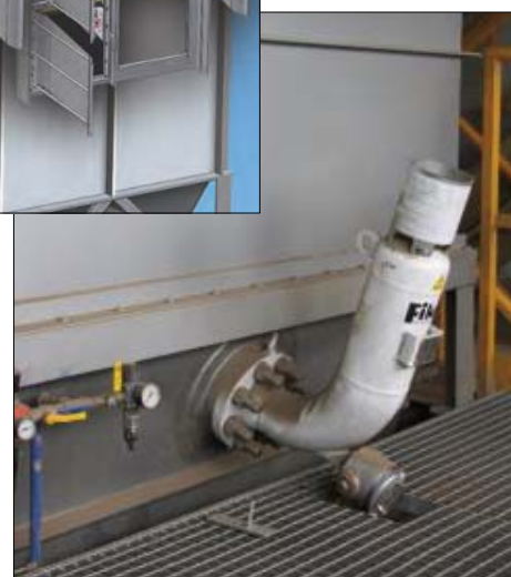
Rys. 8. Butla tłumienia wybuchów typu HRD na filtrze workowym
