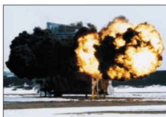
Rys. 1. EKSPLOZJA FILTRA BEZ ZABEZPIECZEŃ
