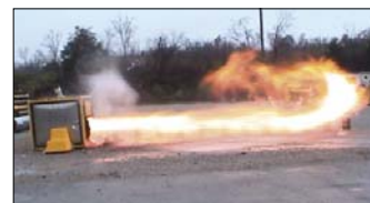
Rys. 10. UKIERUNKOWANE WPROWADZENIE WYBUCHU PRZEZ PŁYTĘ BEZPIECZEŃSTWA
