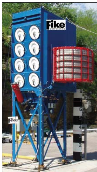
Przerzycznik ognia gotowy do pracy na filtrze
