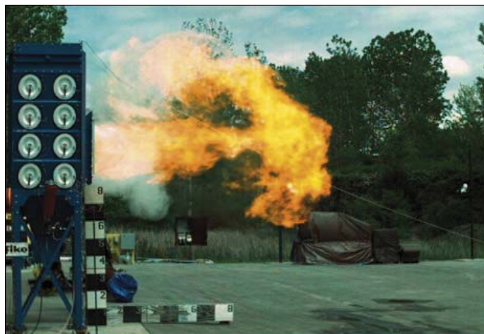
Eksplzja na filtrze kontrolowana za pomocą płyty bezpieczeństwa
